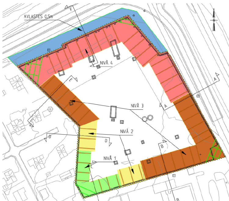
Figur .2.2: Soneinndeling av bermdimensjoner og putehøyde, (NGI, 2023d).
