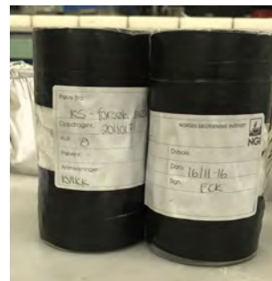
(c) Ferdig innstampet og forseglede prøvepeler
