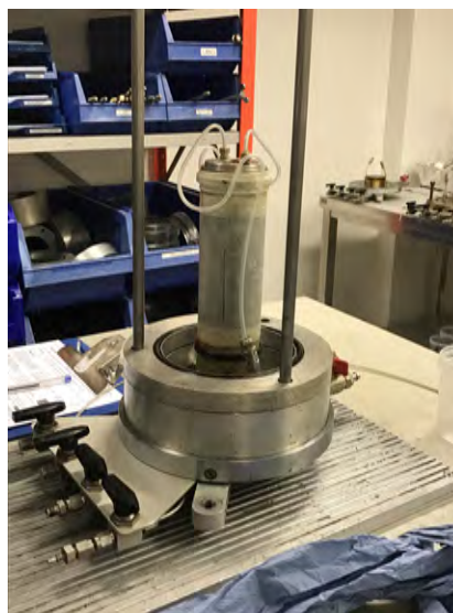
(b) Ferdig installert prøve
