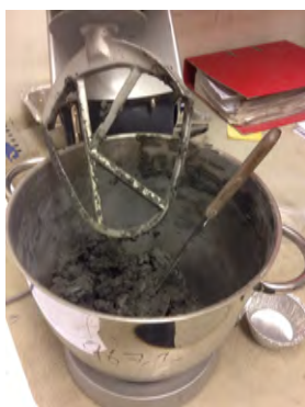
(a) Kenwood kjøkkenmaskin med K-visp benyttet i innblandingen
