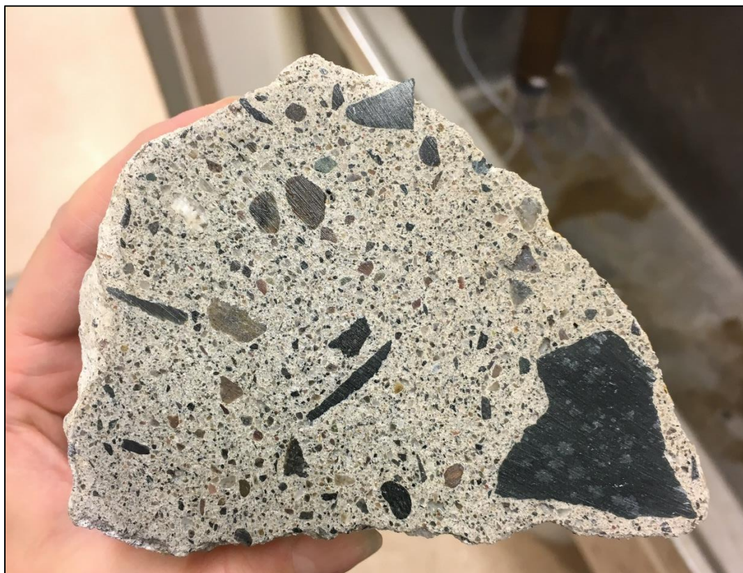
Figur 1: Tverrsnitt av betongmonolitten som ble sendt inn til laboratoriene for analyse av seksverdig krom
