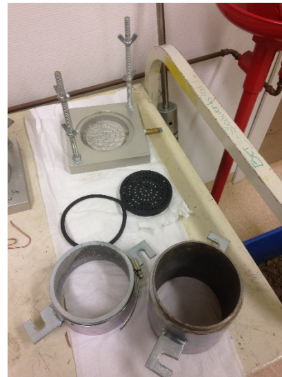
Figur 14 Utførelse av Standard Proctor test: Innstampingsprosedyre (figur til venstre) og utstyr (bilde til høyre) (Kristensen, 2017).
