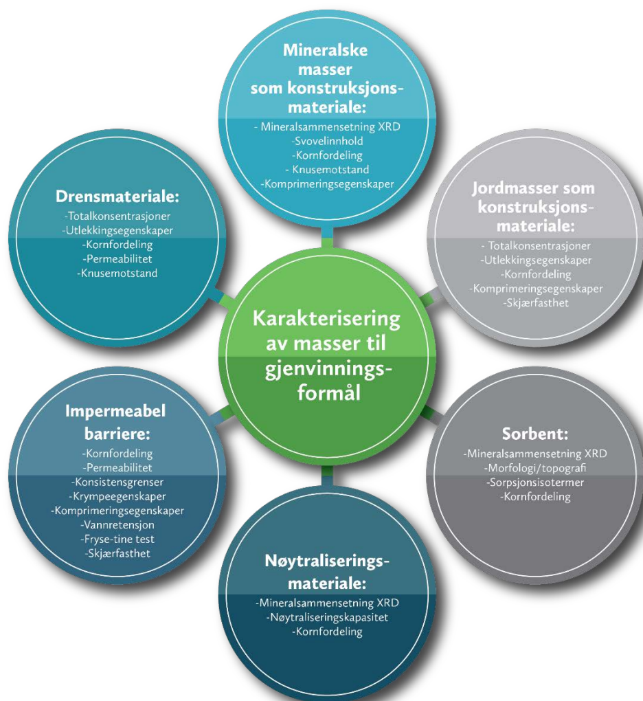
Figur 28 Eksempler på spesifikke tester som kan gjøres på masser som skal benyttes til et utvalg gjenvinningsformål.
