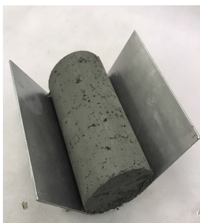
Figur 9 Kalk-sementstabilisert prøve i enaksielt forsøk: Trimmet prøve (venstre) og prøve i trykkapparat (Kristensen, 2017).
