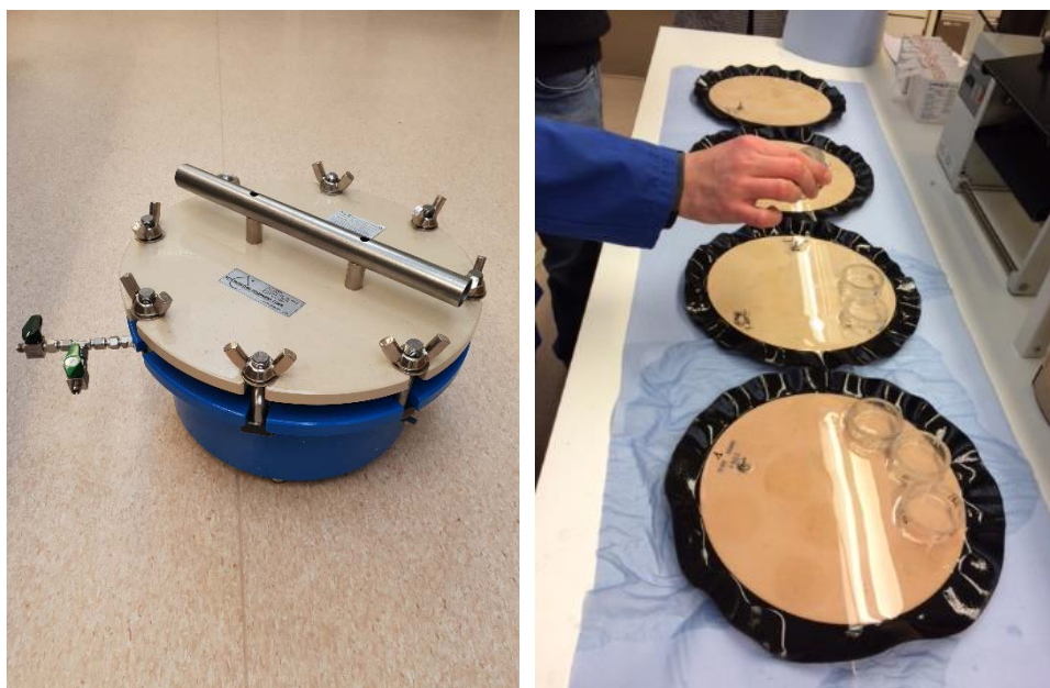
Figur 15 Pressure Plate apparat (venstre) med keramiske plater og prøvekopper (høyre) (Foto: NGI).
