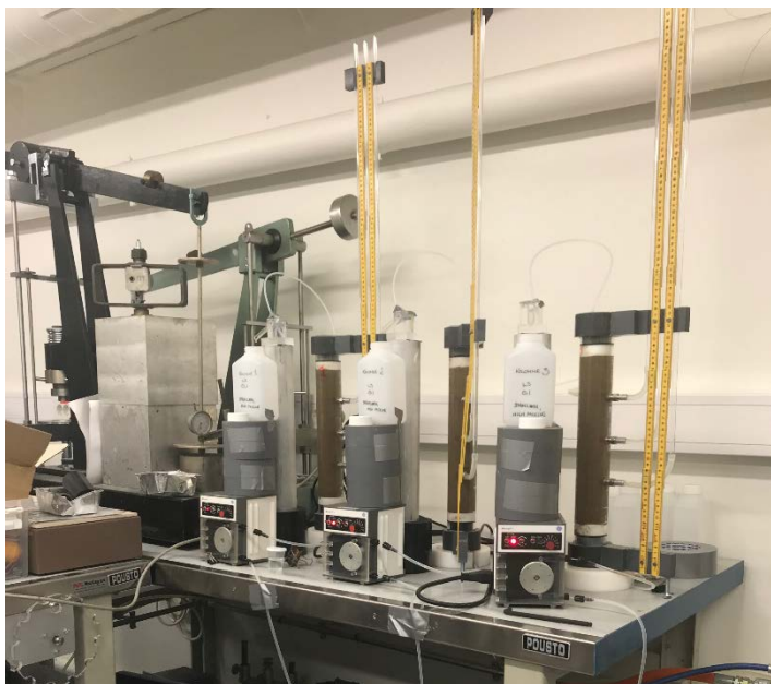
Figur 23 NGI-utviklet kolonnetestoppsett for testing av både permeabilitet og utlekkingspotensiale i samme prøve (Foto: NGI).
