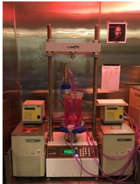
Figur 16 Forsøksoppsett for Chamberlains fryse-tine test. Figur fra Chamberlain (1987) (t.v.). Frostcelle i NGIs laboratorium (t.h.).
