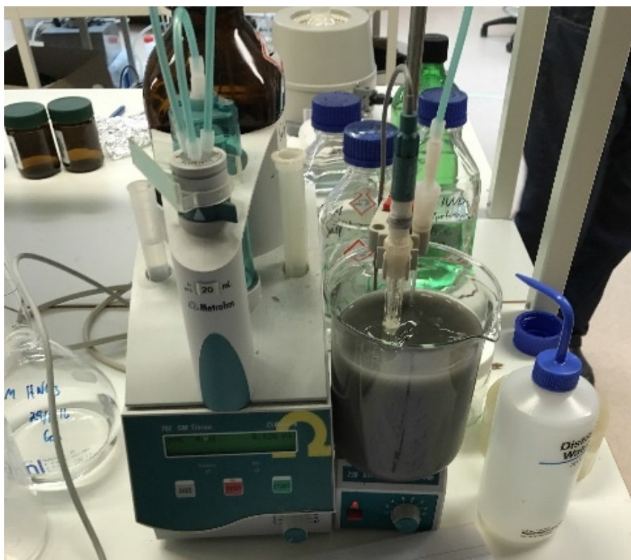
Figur 19 Titrator for å bestemme pH-titreringskurver. Prøven suspenderes i vann med kontinuerlig omrøring (magnetrorer). Syre ( \text{HNO}_3 ) tilsettes for syrenøytraleringstest. Baser ( \text{NaOH} ) tilsettes for basenøytraleringstest. (Foto: NGI)
