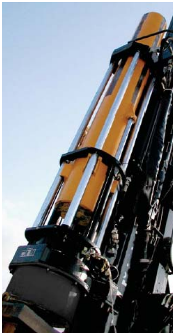
Figur 2: Banut lodd type Superram, kilde: Hjemmesider til leverandør, www.abi-group.com
