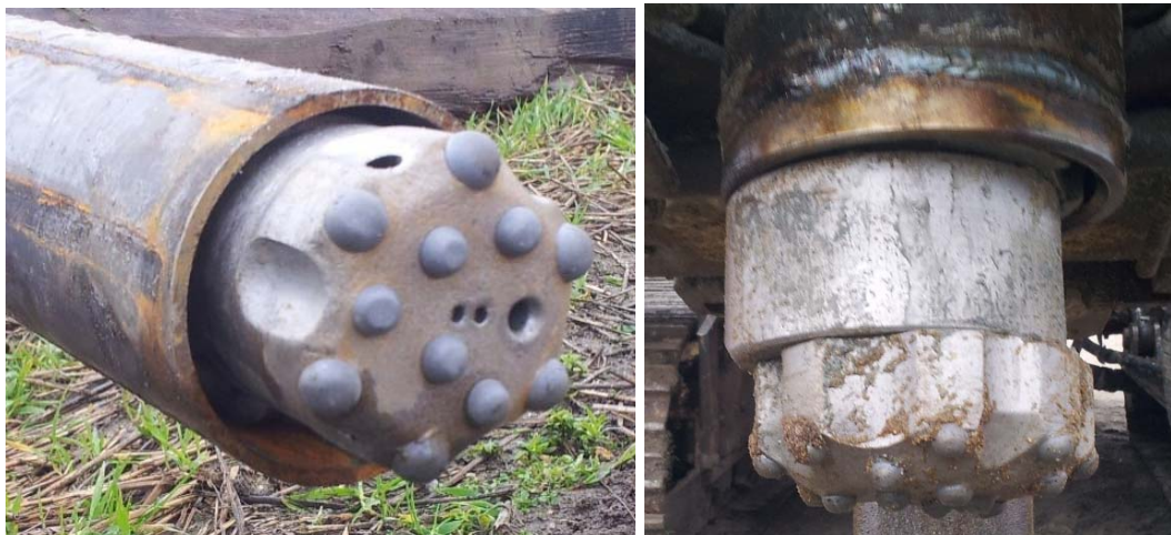
Figur 4-3: Til venstre; bilde av eksentrisk rømmen låst inne i foringsrør. Til høyre; bilde av borkrone med eksentrisk rømmen.
