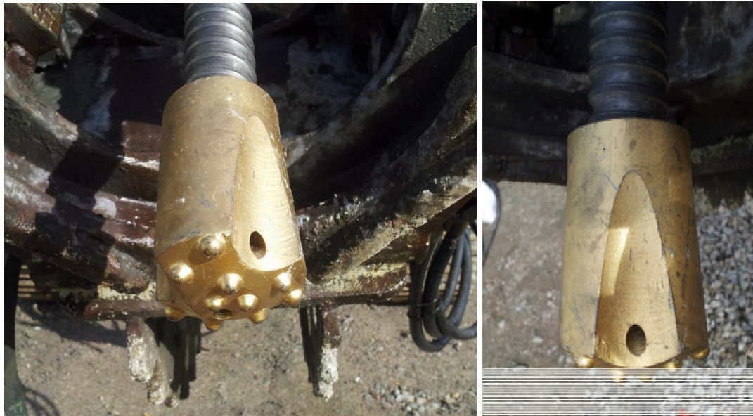
Figur 4-2: Ischebeck stag dimensjon 40/16 med fjellkrone diameter 70 mm.
