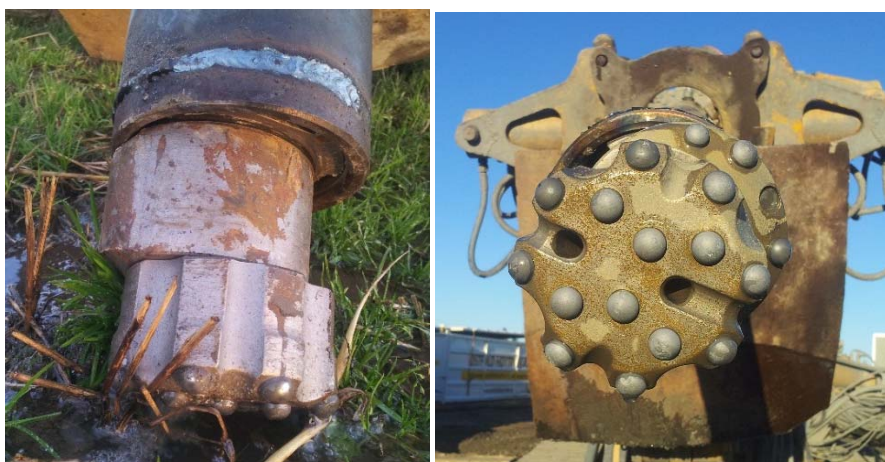
Figur 4-6: Bilder av Odex 115 borkrone benyttet ved boring med Wassara vannhammer i felt C.
