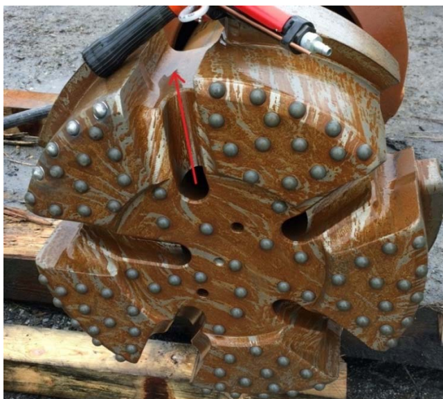
Figur 4-5: Bilde av pilotkrone type Robit DTH ROX+711/16 benyttet til boring av peler for Hobølelva bru med angivelse av spyleretning.
