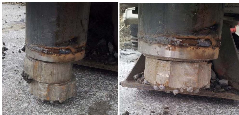
Figur 4-9: Venstre: Odex borkrone med eksentrisk rømmer og pilot. Høyre: Rømmer "låst" fast inne i foringsrør.
