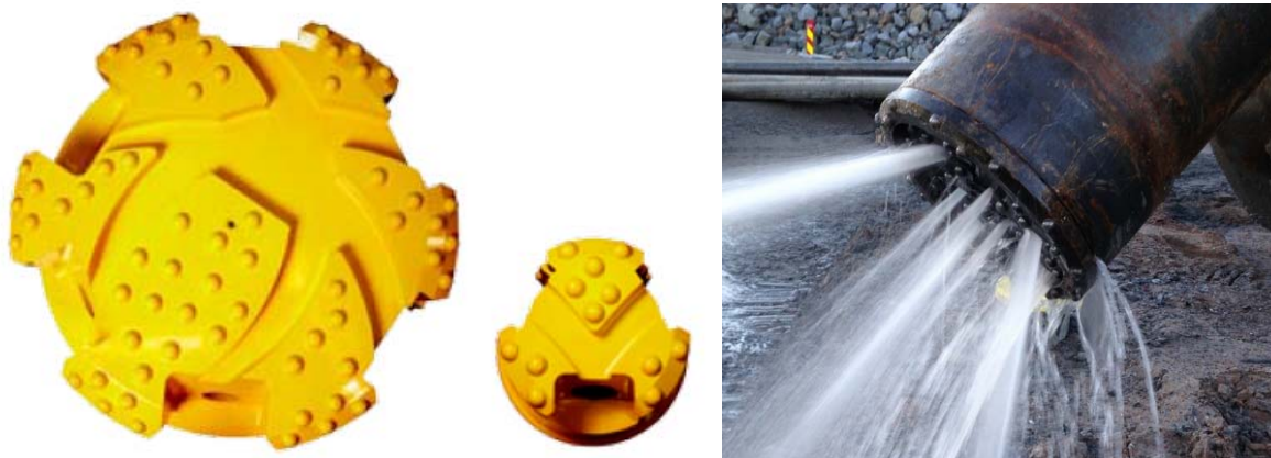
Figur 6-5: Venstre: eksempel Elemex borkrone (Kilde: www.atlascopco.com ). Høyre: bilde som viser pilotkrone trukket inn i forhold til ringkrone og fordeler spylingen framover (Kilde: Geir Veslegard).
