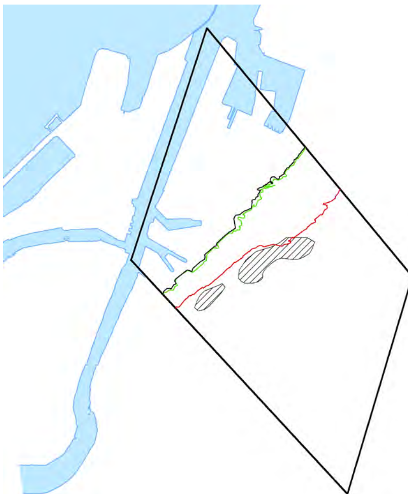
Figur 2-8. Gränser för kvartära avlagringar och modellområde (svart parallelepiped) för grundvattenflödesmodell. Röd linje: Kvikklera avslutas mot berg och överlagras av fyllemassor. Svart linje: Sand avslutas mot siltig lera och med fyllmassor över. Grön linje: Siltig lera avslutas mot kvicklera och överlagras av fyllemassor.
